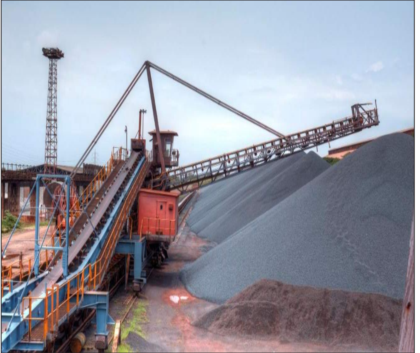
रिक्लेमर ऑफ पैलेट प्लांट, मंगलूरु के माध्यम से पैलेटों की यार्ड में अनलोडिंग किए जाने का दृश्य
